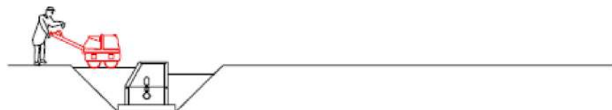
7. Compactació de terres al voltant del pou
