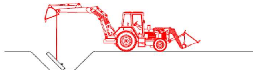
3. Col·locació de la base del pou
