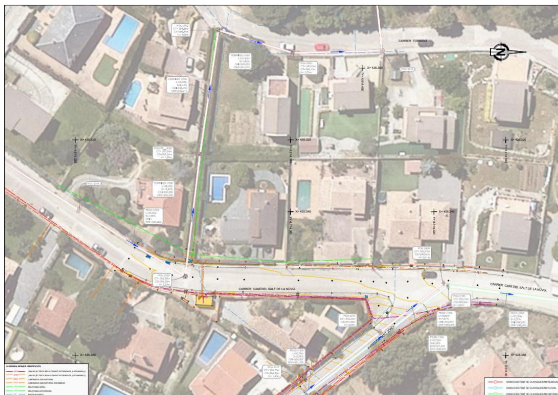
Figura 2: Esquema en planta de la xarxa de clavegueram a la zona àmbit del projecte.
