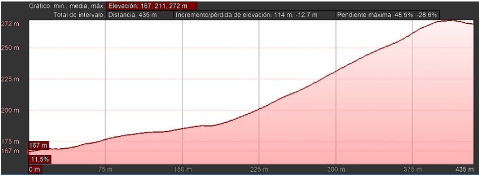
Perfil longitudinal de la nova canonada
