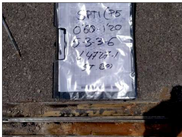
Fotografia 7: ensayo SPT1 (0,60 - 1,20 m).
