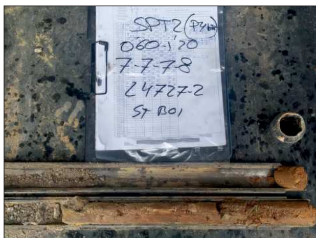
Fotografia 11: ensayo SPT2 (0,60 - 1,20 m).
