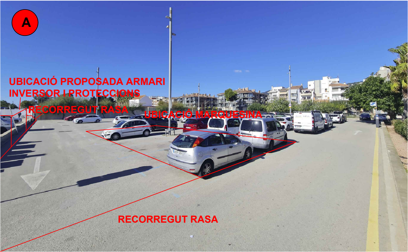
UBICACIÓ DE LA MARQUESINA I RECORREGUT DEL CABLEJAT DE CORRENT CONTÍNUA FINS A L'INVERSOR
