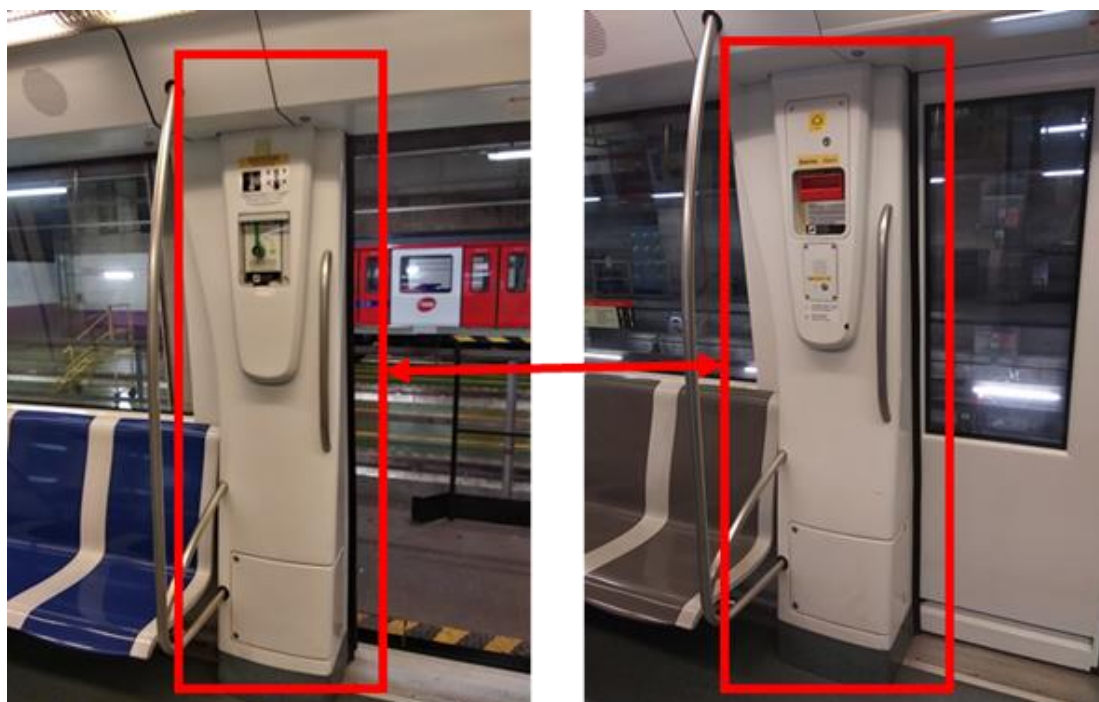
Figura 3.10. Exemple de muntants amb desbloqueig i tirador d'alarma S/9000
