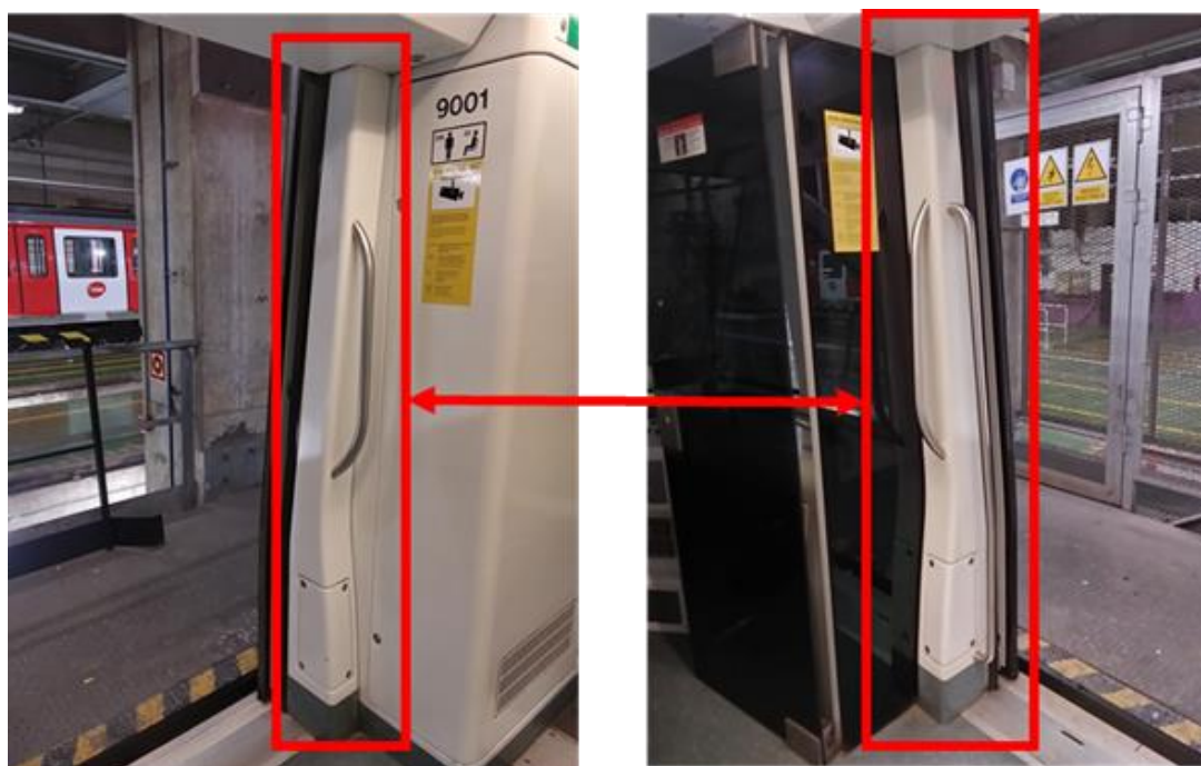
Figura 3.9. Muntant cantonada estret i ample S/9000
