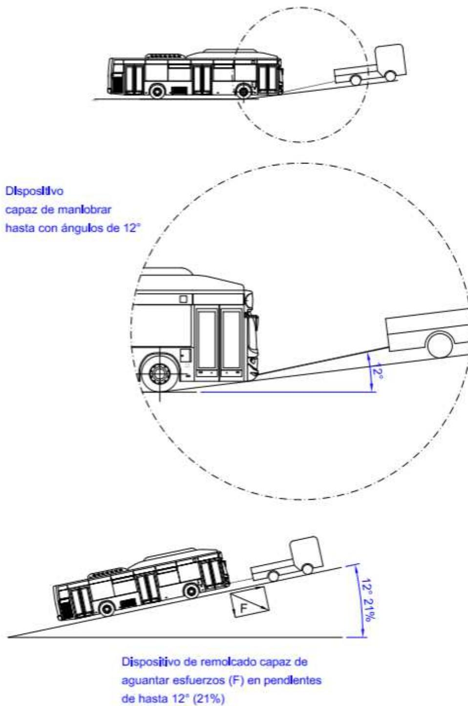
Figura 3. Soporte enganche remolque
