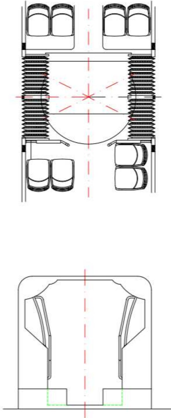
Figura 8. Protección fuele vehículo tipo 3
