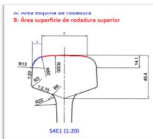
Figura 2: Zona de mecanizado con una pasada, zona roja.
