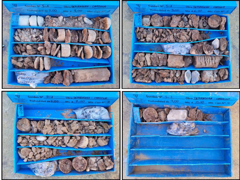
Fotografia 13, 14, 15 i 16. Detall dels materials del nivell 1 recuperat en el sondeig S-1.
