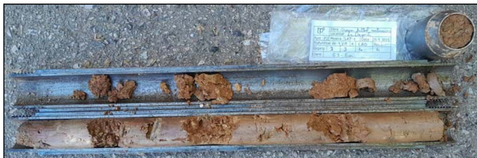
Fotografia 4. Detall dels materials recuperats en l'assaig SPT-1.
