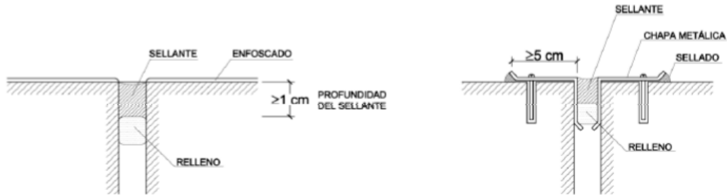
Figura 2.6 Ejemplos de juntas de dilatación
