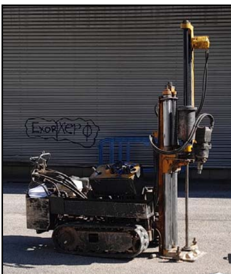
Fotografia 3. Vista de la màquina utilitzada en un dels assaigs de penetració dinàmica DPSH.
