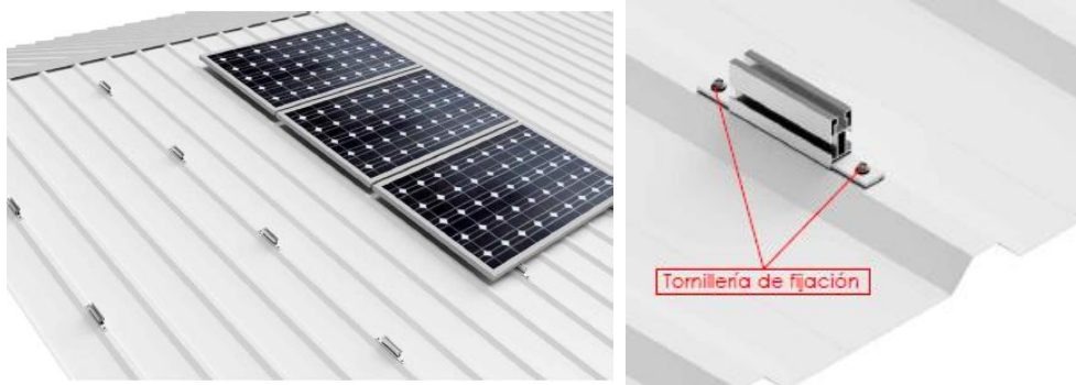
Fig 3. Imatge de la fixació de l'estructura a la coberta de l'edifici
