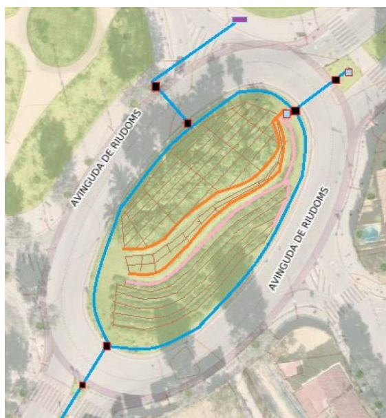
Figura 51. Detalle de la red existente de riego en el interior de la rotonda de la Avenida Riudoms previa a el proyecto. Fuente: Ajuntament de Reus.
