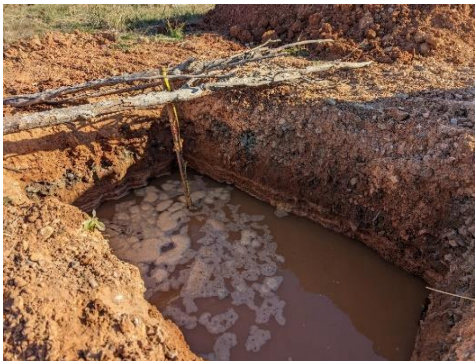
Figura 1. Ensayo de permeabilidad en zanja en Los Belones, Murcia-ES.
