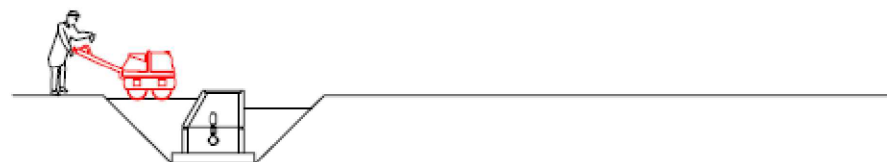
7. Compactació de terres al voltant del pou
