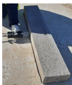
Figura 3. Ensayo para la determinación del coeficiente de fricción estático
