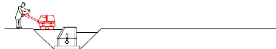
7. Compactació de terres al voltant del pou
