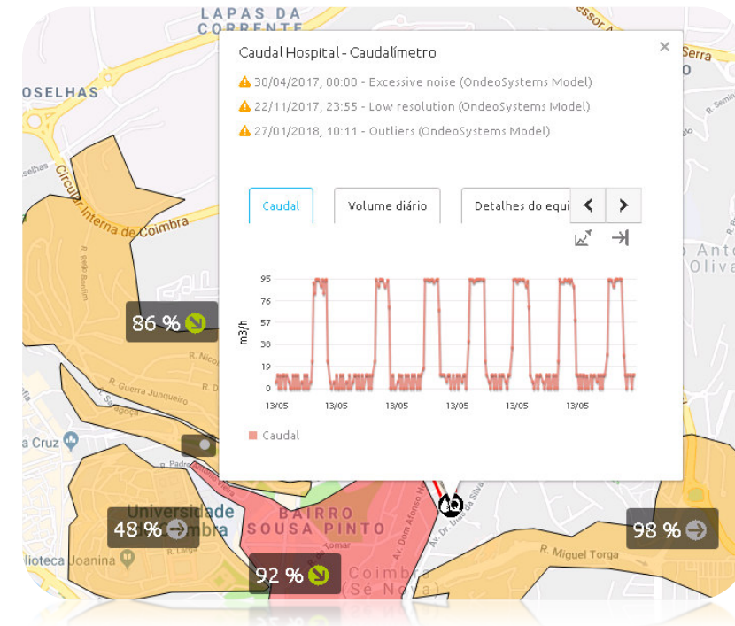
Figura 7 Exemple de visualització de monitorització hidràulica- Elements
