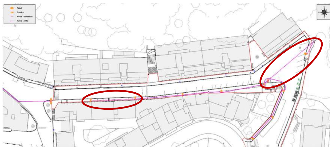
Figura 1. Xarxa enllumenat existent al C/ del Pi
