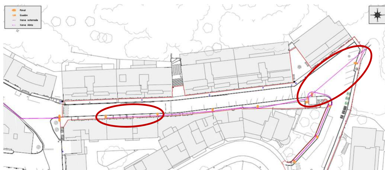
Figura 7. Xarxa enllumenat existent al C/ del Pi. Trams a soterrar.
