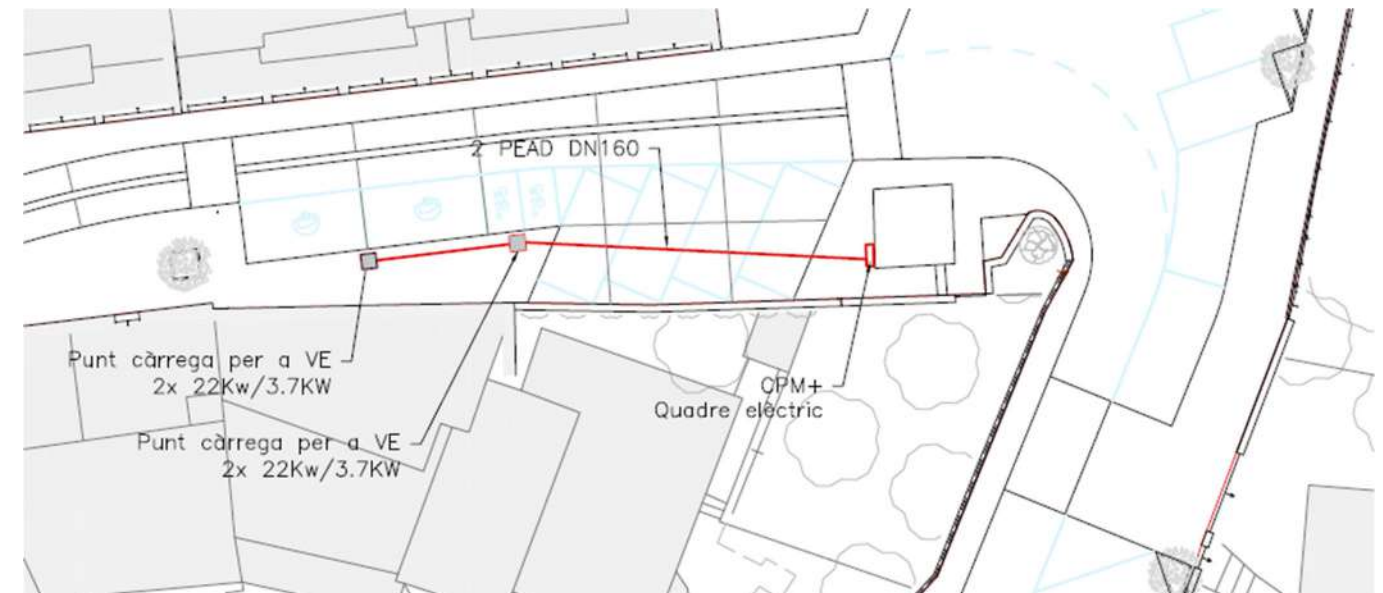
Figura 3. Afectació xarxa electricitat C/ del Pi
