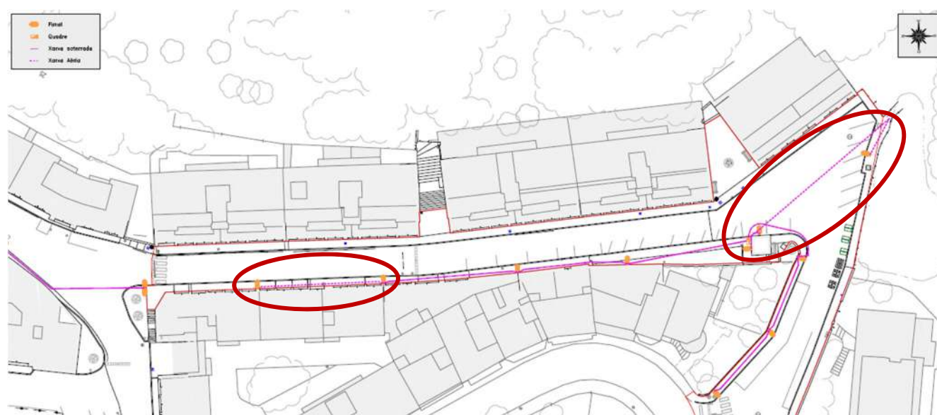
Figura 1. Xarxa enllumenat existent al C/ del Pi. Trams a soterrar.
