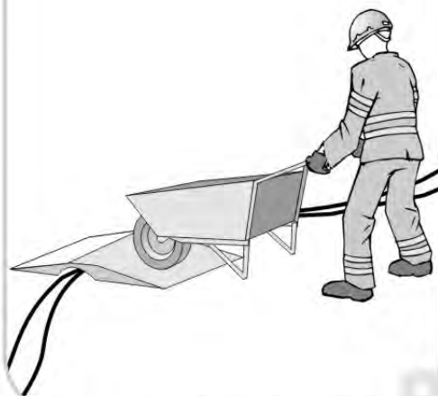
protección de conductores
