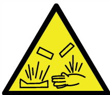
RISC DE CORROSIÓ
