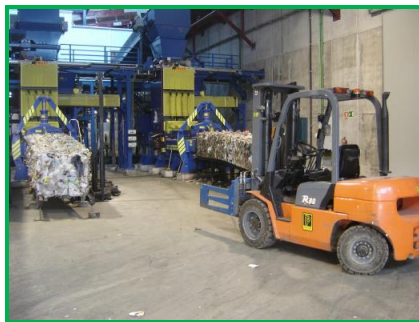
5. Prensado material recuperado
