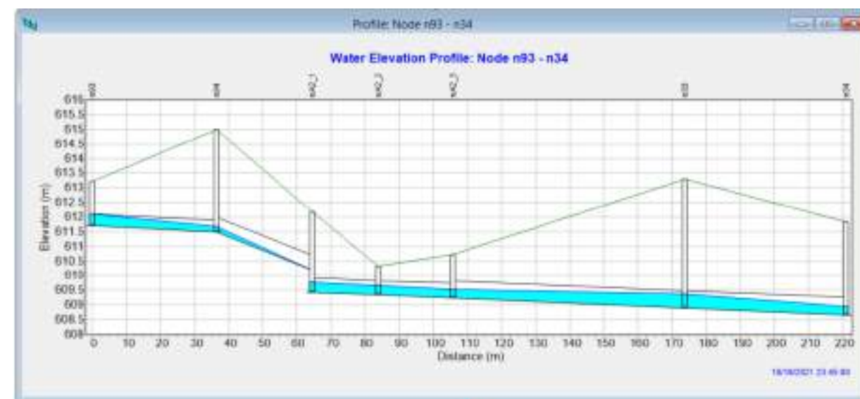
Figura 10. Perfil de calats en el nou tram de col·lectors i pous anterior i posterior per a cabals futurs en temps de pluja i conducció DN600 entre els pous A2_3 i n33.
