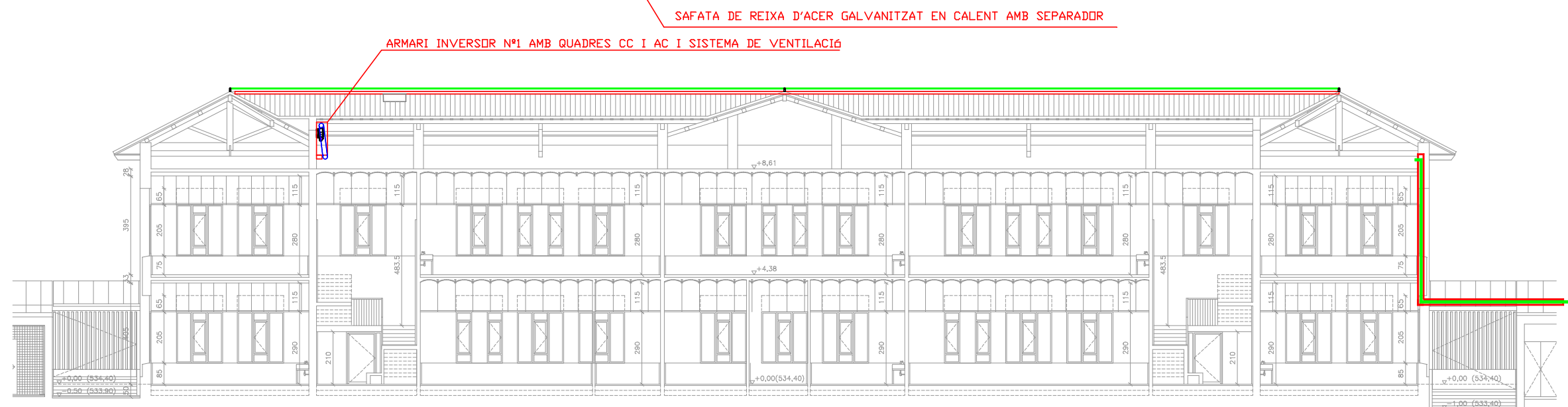
SECCIÓ LONGITUDINAL B-B'
