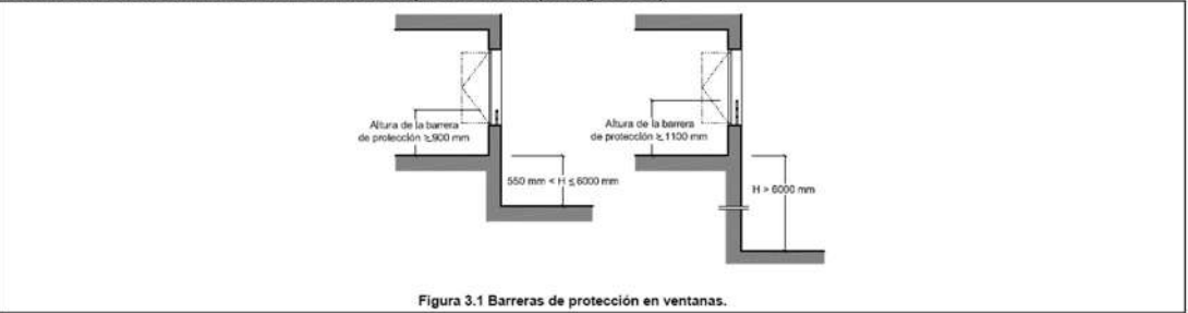
Figura 3.1 Barreras de protección en ventanas.
