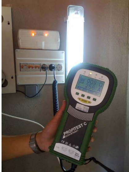
Foto ejemplo: Medida toma tierra con valor de resistencia eléctrica no superior a 10 \Omega respecto de la tierra lejana
