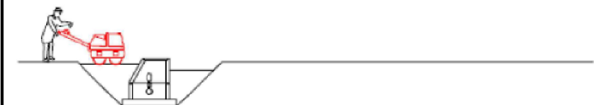
7. Compactació de terres al voltant del pou
