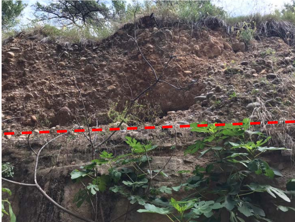
Fotografia -1- La part superior de la ratlla vermella corresponent al material granular i la part inferior a la roca
