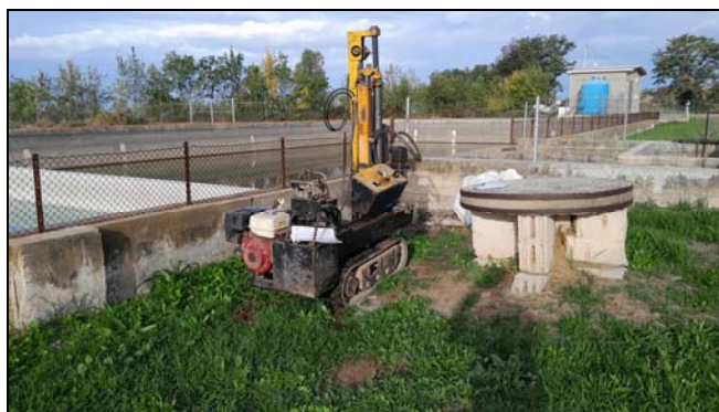
Fotografia 1. Vista de la màquina utilitzada en un dels assaigs de penetració dinàmica realitzats.
