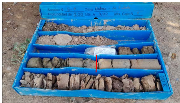
Fotografia 3. Detall dels materials recuperats durant la realització del sondeig S-1.
