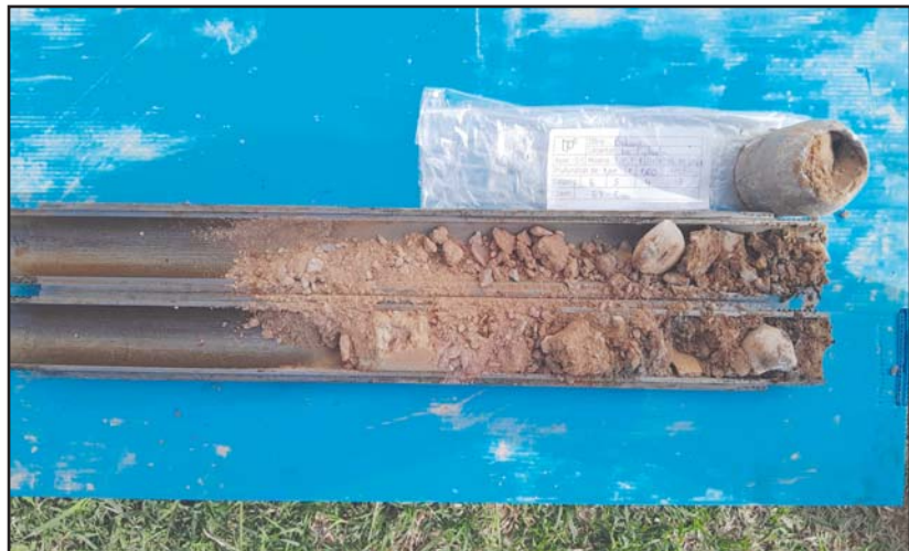
Fotografia 4. Detall del material recuperat en l'assaig SPT-1.
