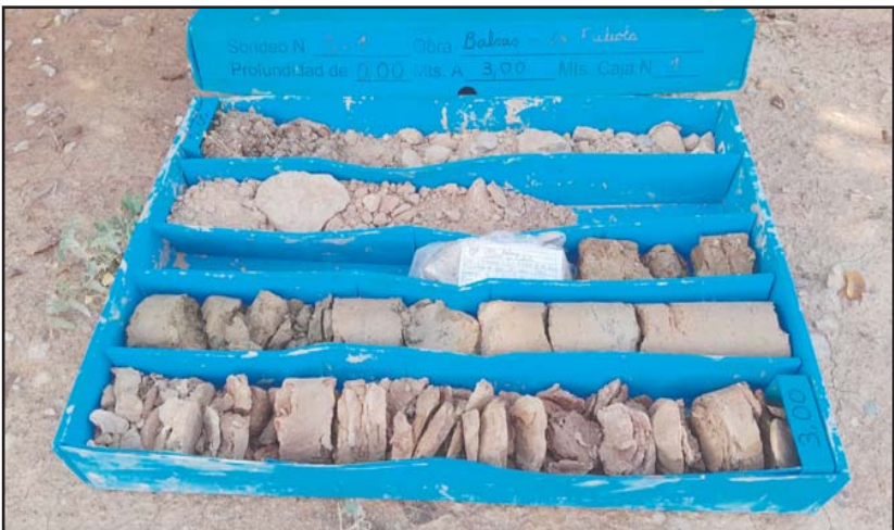
Fotografia 2. Material recuperat en el sondeig S-1 entre les cotes de 0.00 a -3.0 metres de profunditat.
