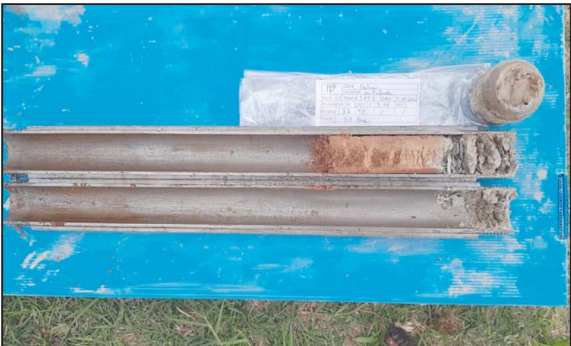
Fotografia 5. Detall del material recuperat en l'assaig SPT-2.
