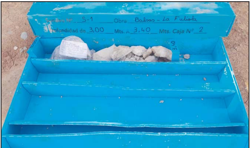
Fotografia 3. Material recuperat en el sondeig S-1 entre les cotes de -3.0 a -3.40 metres de profunditat.
