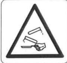
RISC DE CORROSIÓ
