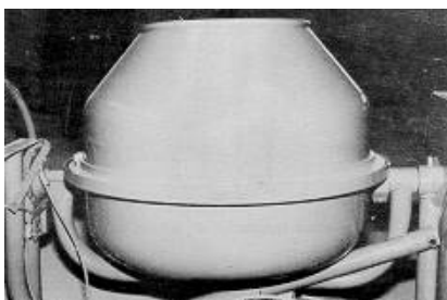
Fig. 11: Protección de la corona y engranaje de rotación de la hormiguera
