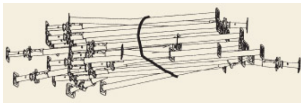
Figura 7 Izado de puntales eslingados de forma incorrecta
