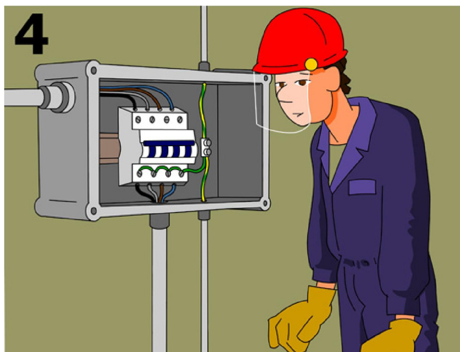
4.- CURT-CIRCUITAR I POSAR A TERRA LA INSTAL·LACIÓ
