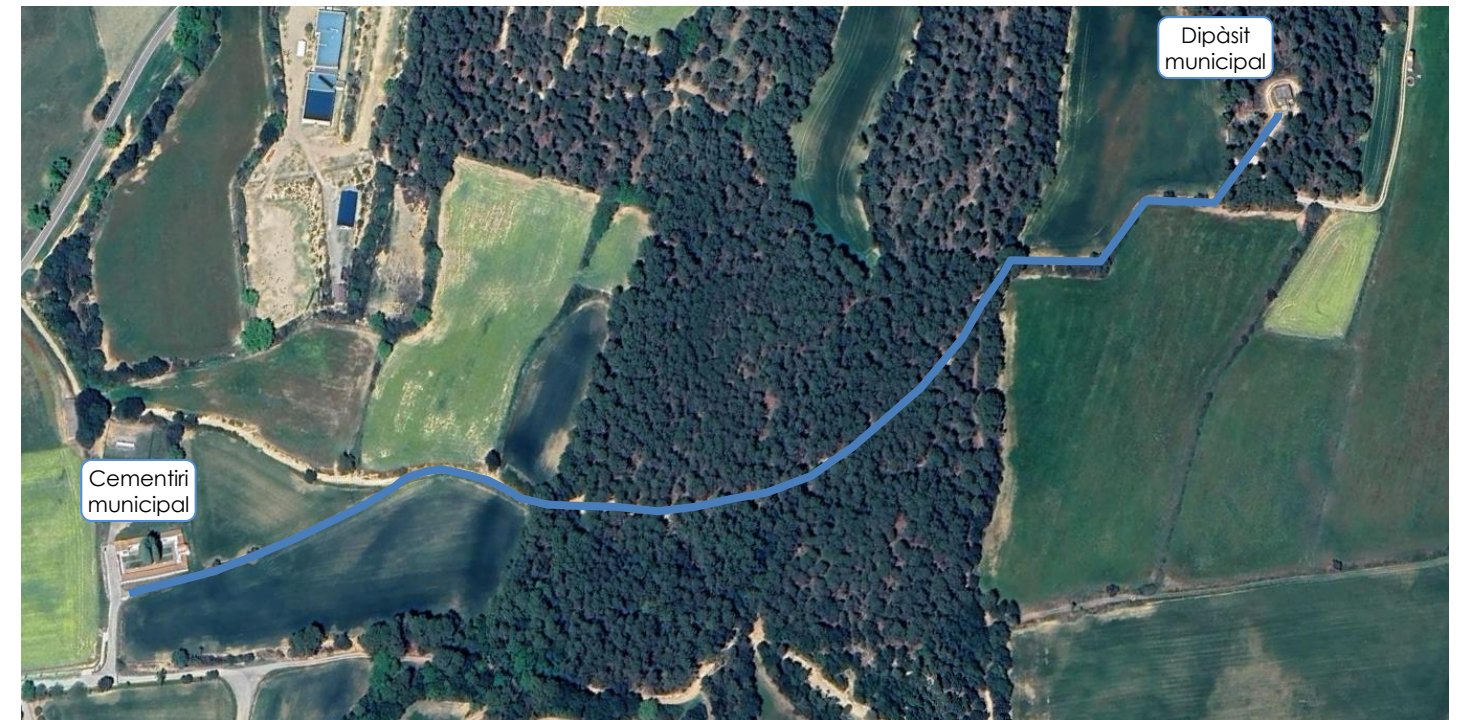
Figura 1. Traçat de la nova canonada de PE DN125 PN16
