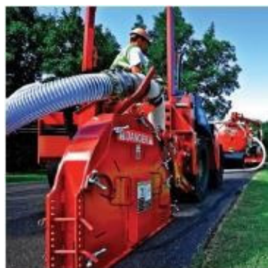
Figura 40. Equip de micro-rasa comercial.
