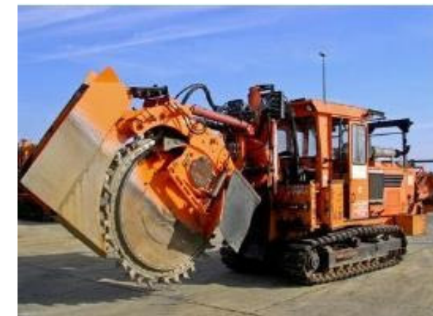
Figura 39. Rasadora de disc de tall.
