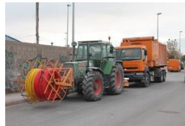
Figura 45. Equip complet de rasa i aspiració.
