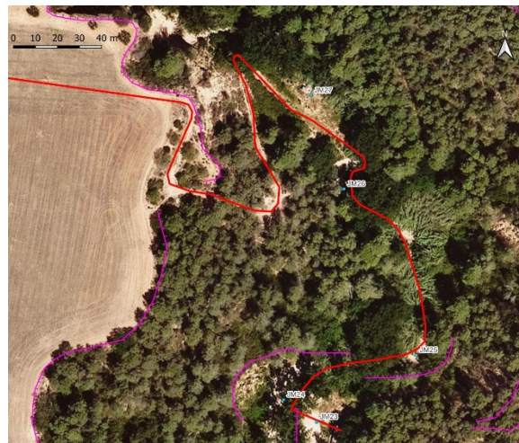
Comparativa del tram del torrent de Can Cairot (punt JM26) on se situa la nova canonada en les ortofos de 1956 (esquerra) i de 2023 (dreta). En lila la coronació actual dels escarpaments i en vermell el traçat previst de la canonada. Extret del servidor de mapes de la web de l'ICGC.
