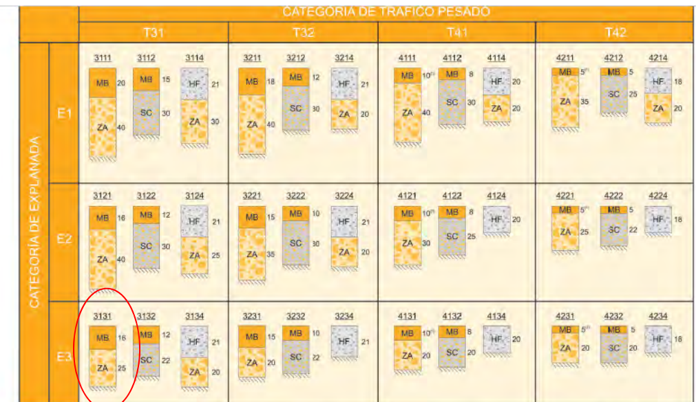
Figura 9. Catàleg de seccions de ferm per a les diferents categories de trànsit pesat T31 a T41 en relació a la categoria d'esplanada
