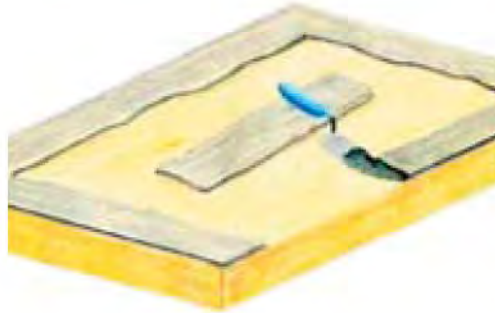
Figura 4. Detalles del pegado borde-punto de las planchas de aislamiento
