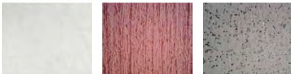
Figura 34. Texturas con efecto dado por rodillo de trapeado, con efecto por llana dentada triangular y liso con áridos proyectados
