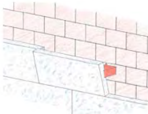
Figura 21. Detalle de la instalación de las planchas de aislamiento en la fachada de un edificio
