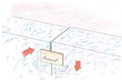
Figura 23. Lijado de los planchas de aislamiento
