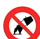
PROHIBIT APAGAR AMB AIGUA
