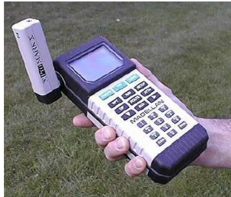
Figura nº 2.- Receptor GPS de mà (handheld GPS)
