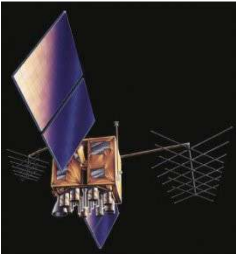
Figura 1.- Satèl·lit NAVSTAR (NAVSTAR: NAVigation System with Timing And Ranging)
