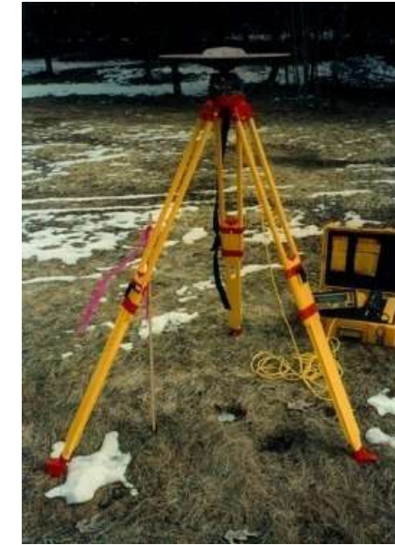
Figura nº 3.- Estació GPS base utilitzada per a realitzar correccions diferencials
