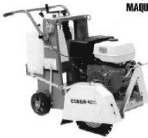
CORTADORA JUNTA DE DILATACIÓN
