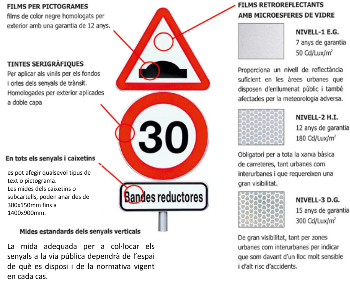
Figura 86. Característiques tipus senyals verticals part frontal.
