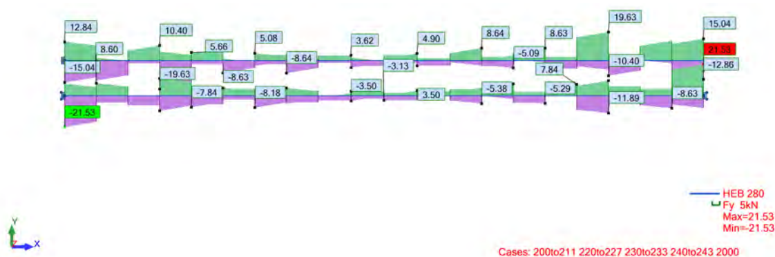
Figura 23: Vierendeel. Tallants horitzontals
