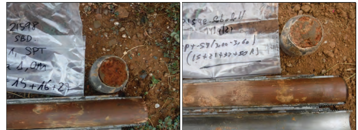
Materials argilosos de la capa A en dos assaigs SPT.
