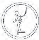
USO DE CINTURON DE SEGURIDAD
