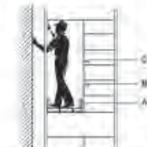
COLOCAR BARANDILLA, LISTÓN INTERMEDIO Y RODAPIÉ. A= 15 cm; B= 35 cm; C= 40 cm
