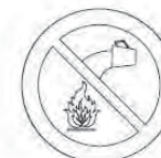
PROHIBIDO APAGAR CON AGUA
