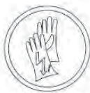
USO DE GUANTES DIELECTRICOS
