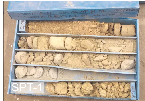
Fotografia 2. Material recuperat en el sondeig S-4 entre les cotes de 0.00 a -3.00 metres de profunditat.
