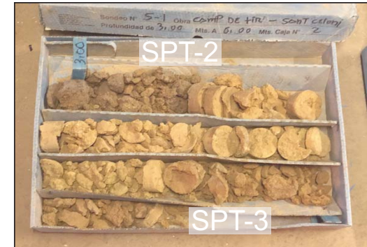
Fotografia 3. Material recuperat en el sondeig S-1 entre les cotes de -3.00 a -5.91 metres de profunditat.
