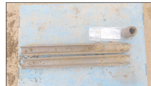
Fotografia 6. Detall dels materials recuperats en l'assaig SPT-3.
