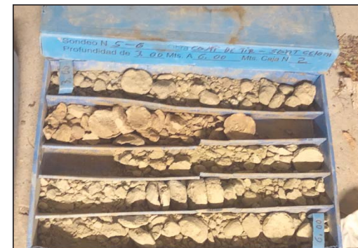
Fotografia 3. Material recuperat en el sondeig S-6 entre les cotes de -3.00 a -6.00 metres de profunditat.
