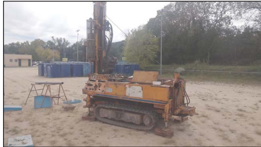
Fotografia 1. Vista de l'emplaçament de la màquina per a la realització del sondeig a rotació amb bateria continua S-5.
