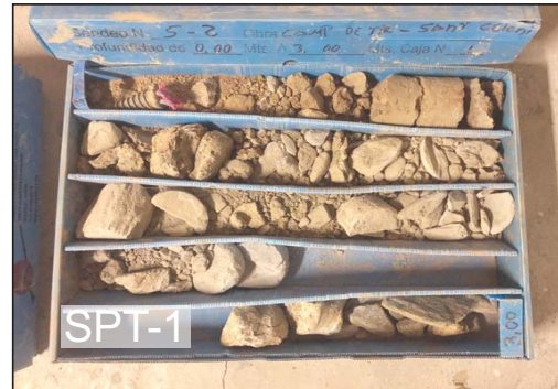
Fotografia 2. Material recuperat en el sondeig S-2 entre les cotes de 0.00 a -3.00 metres de profunditat.
