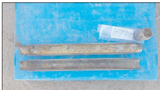
Fotografia 4. Detall dels materials recuperats en l'assaig SPT-1.
