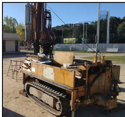
Fotografia 3. Vista de la màquina utilitzada per a la realització del sondeig a rotació S-1.
