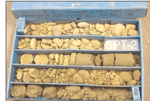
Fotografia 3. Material recuperat en el sondeig S-4 entre les cotes de -3.00 a -6.00 metres de profunditat.
