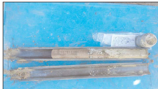
Fotografia 5. Detall dels materials recuperats en l'assaig SPT-2.
