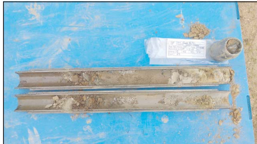
Fotografia 4. Detall dels materials recuperats en l'assaig SPT-1.
