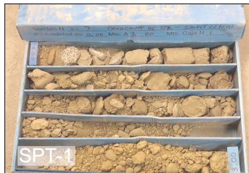
Fotografia 2. Material recuperat en el sondeig S-3 entre les cotes de 0.00 a -3.00 metres de profunditat.
