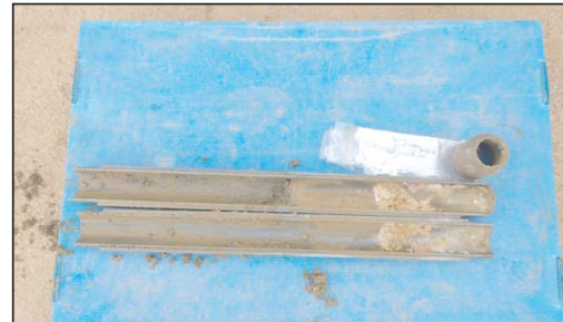
Fotografia 5. Detall dels materials recuperats en l'assaig SPT-2.
