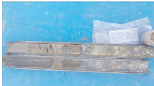
Fotografia 4. Detall dels materials recuperats en l'assaig SPT-1.
