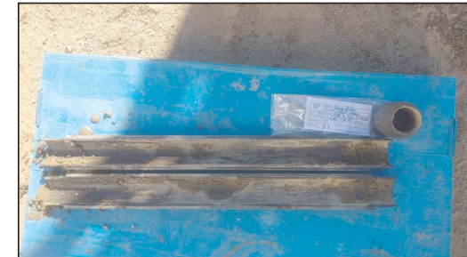
Fotografia 6. Detall dels materials recuperats en l'assaig SPT-3.
