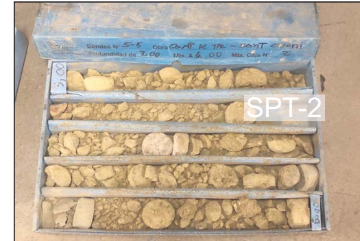
Fotografia 3. Material recuperat en el sondeig S-5 entre les cotes de -3.00 a -6.00 metres de profunditat.
