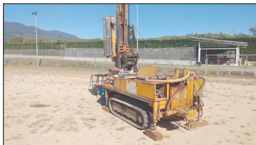
Fotografia 1. Vista de l'emplaçament de la màquina per a la realització del sondeig a rotació amb bateria continua S-6.
