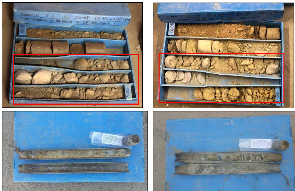
Fotografia 7, 8, 9 i 10. Detall dels materials recuperats durant la realització del sondeigs, que s'identifiquen com a materials del nivell 2.
