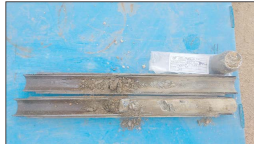
Fotografia 5. Detall dels materials recuperats en l'assaig SPT-2.
