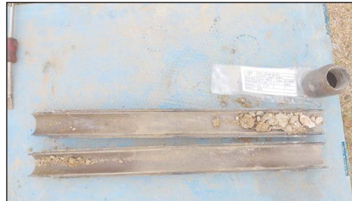
Fotografia 5. Detall dels materials recuperats en l'assaig SPT-2.
