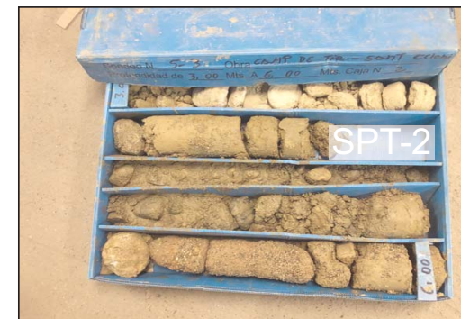
Fotografia 3. Material recuperat en el sondeig S-3 entre les cotes de -3.00 a -6.00 metres de profunditat.
