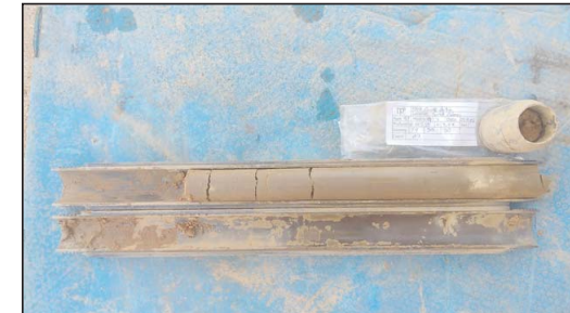
Fotografia 6. Detall dels materials recuperats en l'assaig SPT-3.
