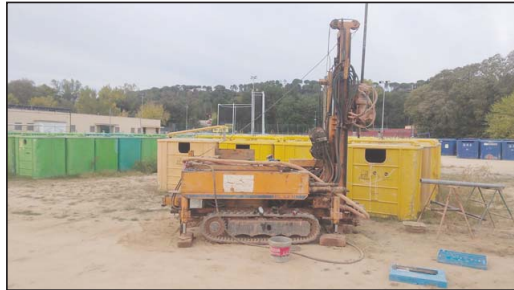
Fotografia 1. Vista de l'emplaçament de la màquina per a la realització del sondeig a rotació amb bateria continua S-4.
