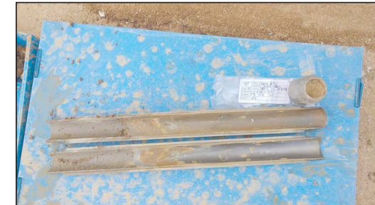
Fotografia 6. Detall dels materials recuperats en l'assaig SPT-3.
