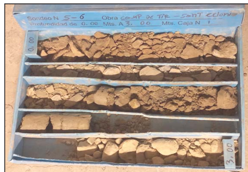
Fotografia 2. Material recuperat en el sondeig S-6 entre les cotes de 0.00 a -3.00 metres de profunditat.
