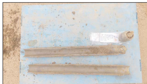
Fotografia 5. Detall dels materials recuperats en l'assaig SPT-2.
