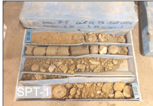
Fotografia 2. Material recuperat en el sondeig S-5 entre les cotes de 0.00 a -3.00 metres de profunditat.
