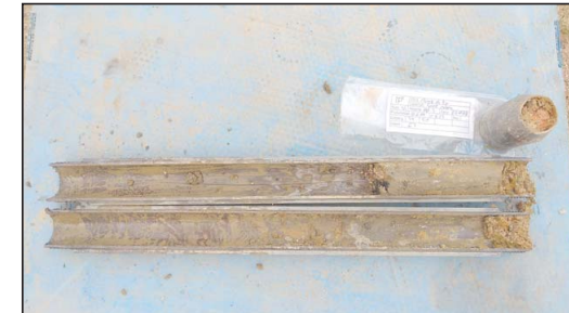
Fotografia 6. Detall dels materials recuperats en l'assaig SPT-3.
