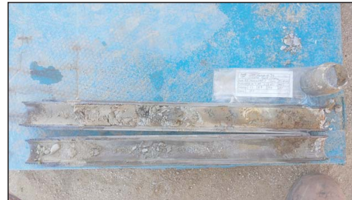
Fotografia 5. Detall dels materials recuperats en l'assaig SPT-2.
