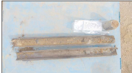
Fotografia 4. Detall dels materials recuperats en l'assaig SPT-1.
