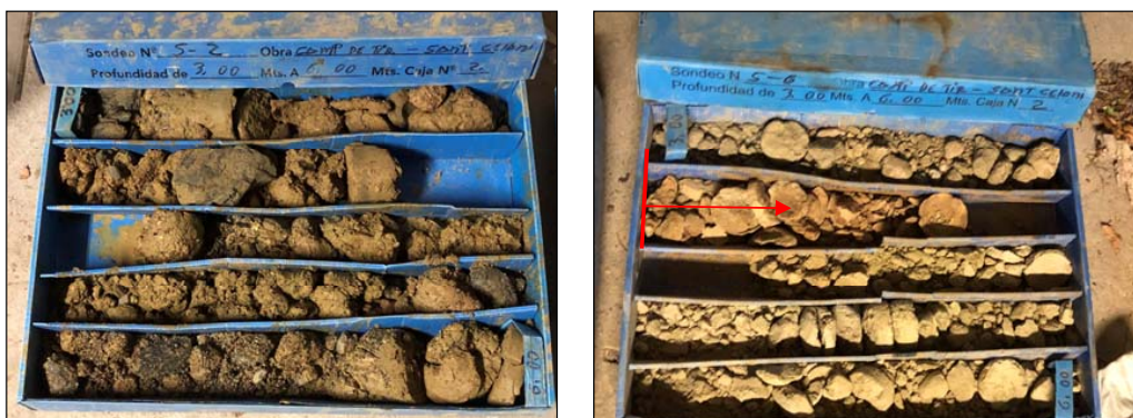
Fotografia 11 i 12. Detall dels materials recuperats durant la realització del sondeigs, que s'identifiquen com a materials del nivell 3, a l'esquerra els trams amb més graves i a la dreta els trams més sorrenços.
