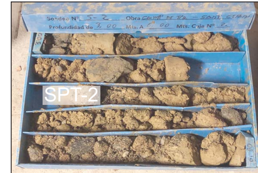
Fotografia 3. Material recuperat en el sondeig S-2 entre les cotes de -3.00 a -6.00 metres de profunditat.
