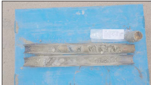
Fotografia 4. Detall dels materials recuperats en l'assaig SPT-1.
