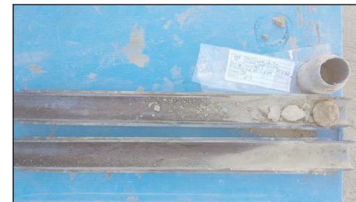
Fotografia 6. Detall dels materials recuperats en l'assaig SPT-3.
