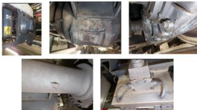
UT2: Motor de tracción, timonería de freno, reductora, antena ATP-ATO y panel neumático
