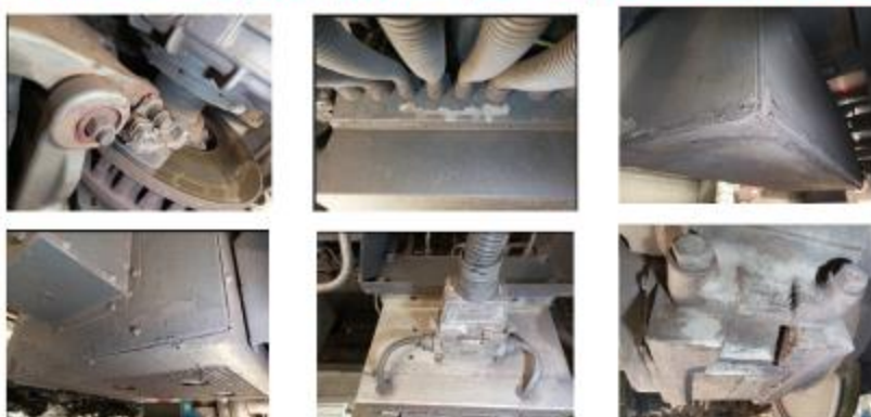
UT21:- Timonería de freno, caja CC15, cofre ATP/ATO, cofre SELF, panel neumático, motor de tracción
