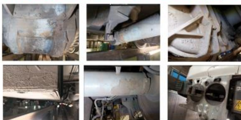
UT11: Motor de tracción, amortiguador transversal, reductora, cofre ATP, eje, enganche
