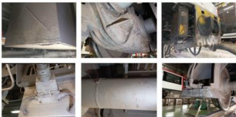
UT3: Cofre ATP, reductora, enganche, panel neumático, eje y antena ATP-ATO
