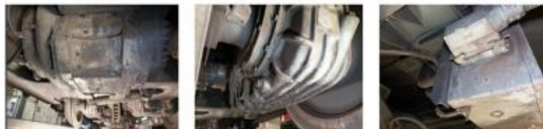
UT9: Motor de tracción, reductora, cofre SELF
