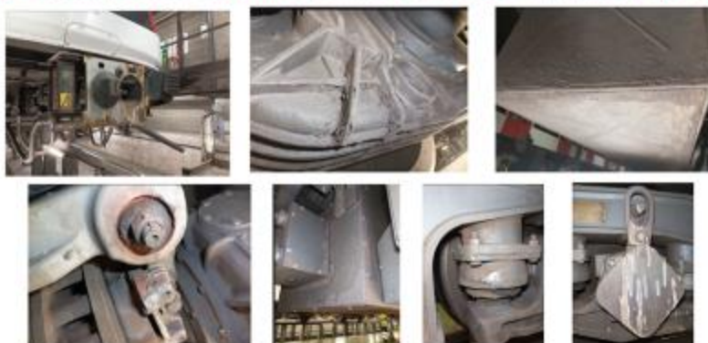
UT22:- Enganche, reductora, cofre ATP/ATO, timonería de freno, cofre SELF, primaria, caja de grasa
