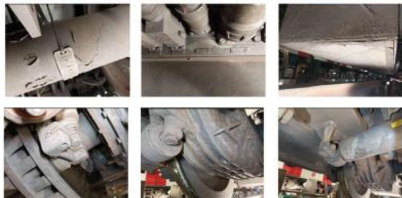
UT15:- Cofre ATP, reductora, motor de tracción, cofre SELF, caja CC62, enganche
