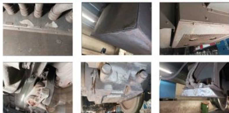
UT18:- Enganche, motor de tracción, cofre ATP/ATO
