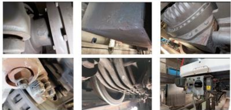
UT14:- Eje, caja CC15, cofre ATP, timonería de freno, reductora, amortiguador transversal
