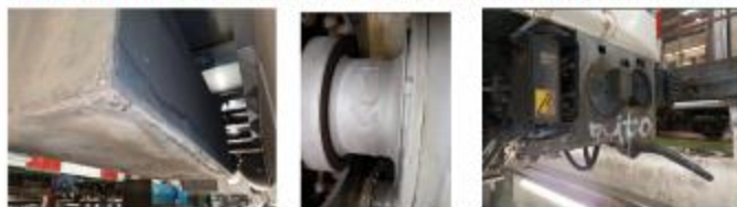
UT8: Cofre ATP, eje, enganche, motor de tracción, reductora, panel neumático
