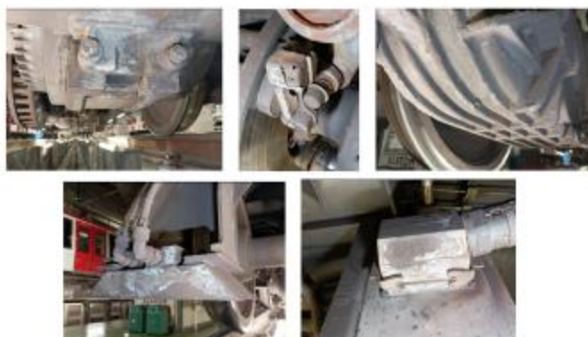
UT3: Cofre ATP, reductora, enganche, panel neumático, eje y antena ATP-ATO
