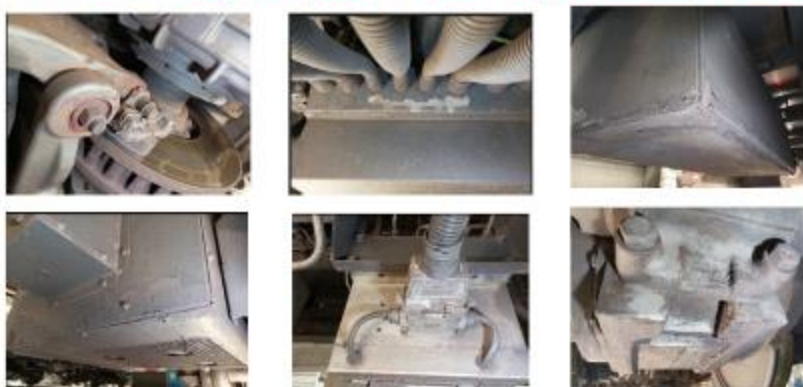
UT21:- Timonería de freno, caja CC15, cofre ATP/ATO, cofre SELF, panel neumático, motor de tracción
