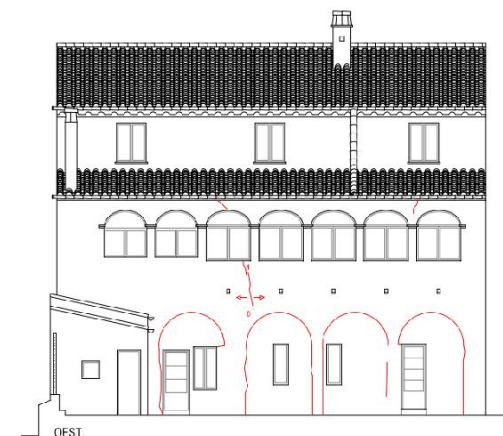
Plànol fissures façana oest
