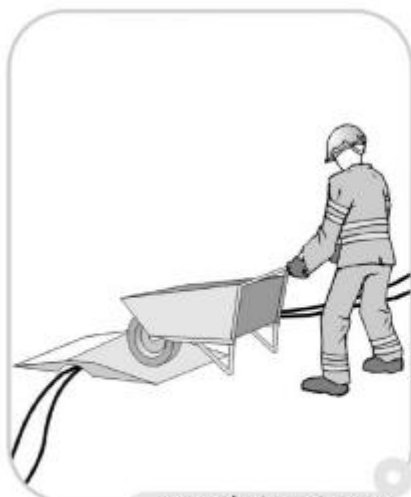
protección de conductores
