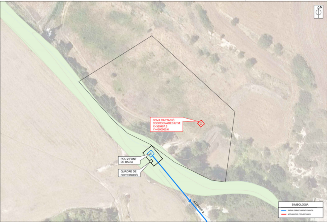
Figura 1 Planta ubicació de la nova captació
