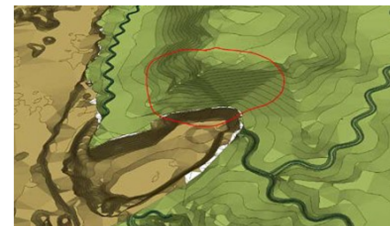
Figura 10. Zona de màxima pendent en la zona pròxima a la tolla
