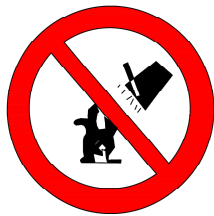
PROHIBIT APAGAR AMB AIGUA
