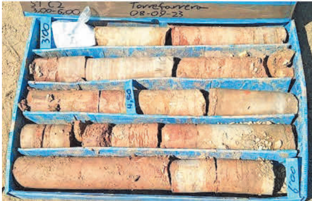
Detall del gres amb intercalacions de lutita (ST) extret del sondeig S-1
