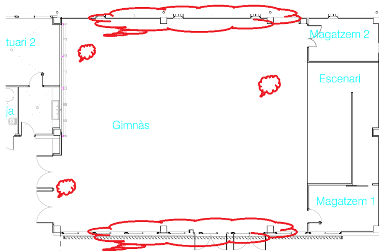
Imatge 3: Zona de filtracions d'aigua a 23/05/2024
