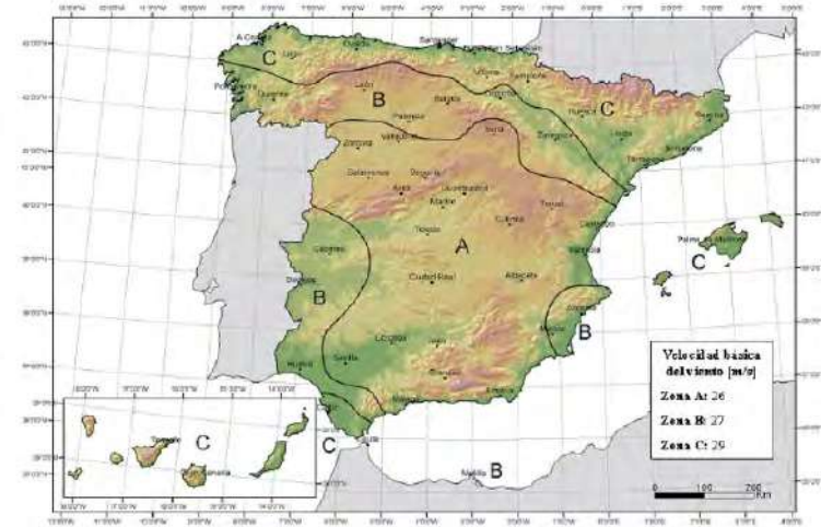
Figura AN.1 - Mapa de isotacas de la velocidad básica fundamental del viento v_{b,0}
